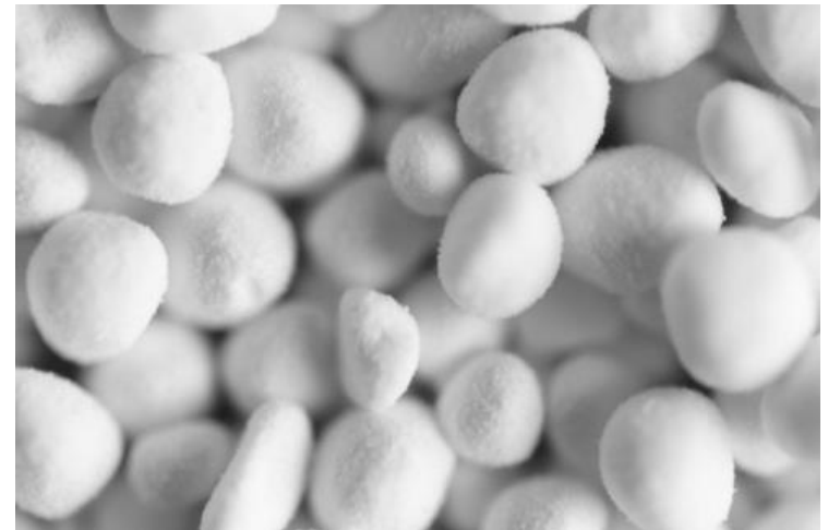
Pebbles aus Silikatstaub (B. Gundlach, IGEP) Primärteilchen 0.5-10µm, Porosität ~70%
