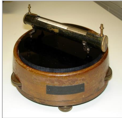
Künstlicher Horizont mit Sekundenlibelle von Carl Bamberg
